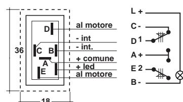
Supporto completo di due interruttori basculanti con micro movimento LUMINOSI CON LED
