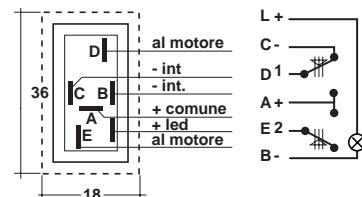
Basculante con micro movimento LUMINOSO CON LED
