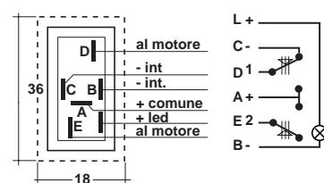
Basculante con micro movimento LUMINOSO CON LED
