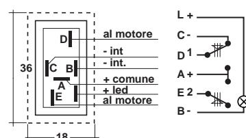
Basculante con micro movimento LUMINOSO CON LED
