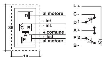
Supporto completo di 4 interruptori basculanti con micro movimento LUMINOSO CON LED VERDE
